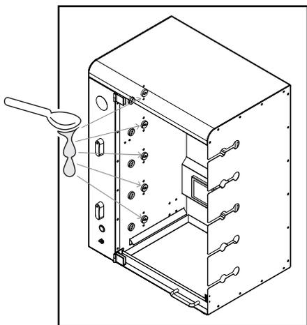
Antes do uso, o usuário deve pingar de duas a três gotas de óleo de cozinha nos mancais internos (figura ao lado) para melhor funcionamento. Cuidar para não escorrer dentro do assador.
